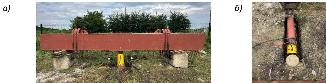
Рис. 5. Конструкции стендов для испытаний БИС с ТВШ:
